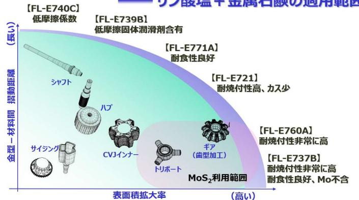
FINELUBEは、リン酸塩+金属石鹼に迫る加工適用範囲!
