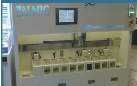
精密モータコアのバルミック処理量産機 (JPCA2016展示品)量産機の1/4規模
